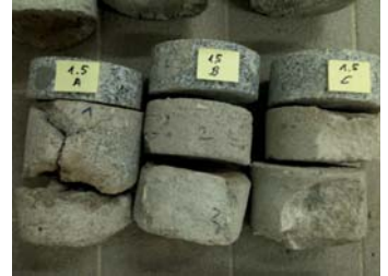
1.5 Bohrkern - Granitplatte auf stark porösem Bettungsmörtel und Unterboden, kein Schichtenverbund vorhanden
